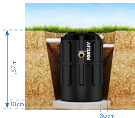
Figura 3 – Instalação sem laje de fechamento.
