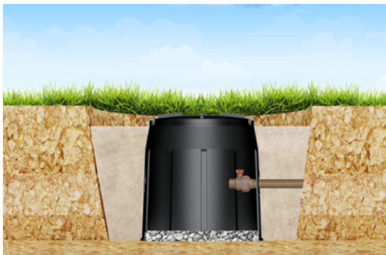
Figura 13 - Instalação hidráulica Leito de Secagem.
