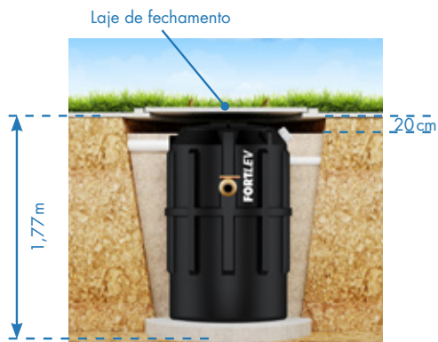
Figura 4 – Instalação com laje de fechamento.
