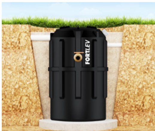
Figura 8 – Aterro completo com compactação.
