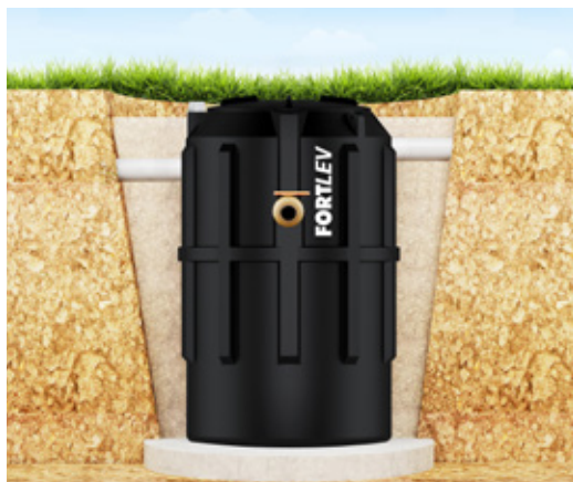
Figura 8 – Aterro completo com compactação.
