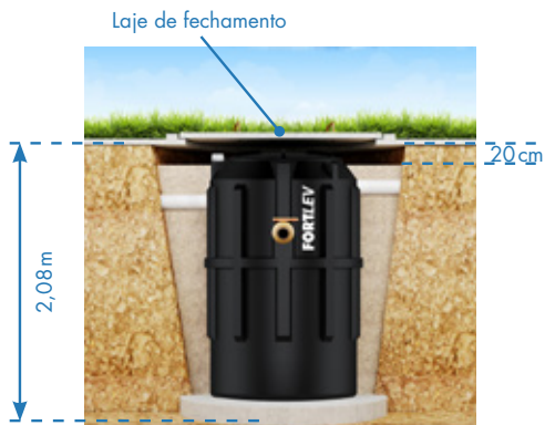
Figura 4 – Instalação com laje de fechamento.
