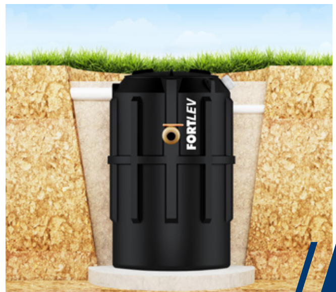
Figura 8 – Aterro completo com compactação.
