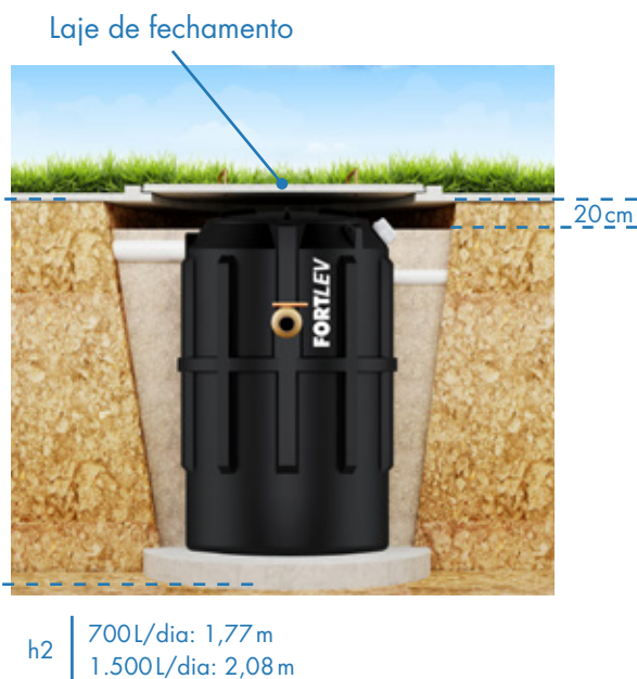
Figura 4 – Instalação com laje de fechamento.
