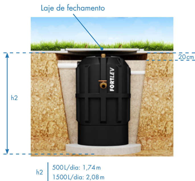
Figura 4 – Instalação com laje de fechamento.
