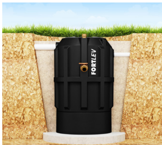
Figura 8 – Aterro completo com compactação.
