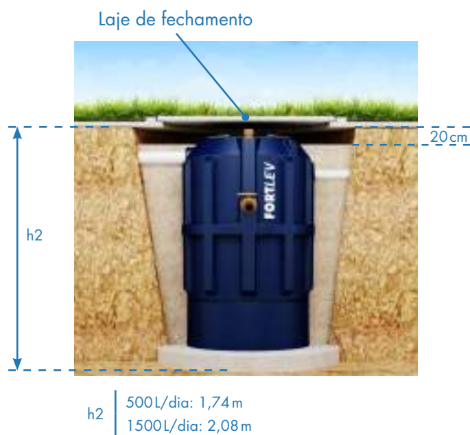
Figura 4 – Instalação com laje de fechamento.
